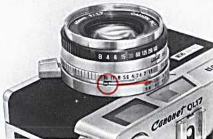
Selbstverständlich funktioniert der Selbstauslöser auch mit Blitzlicht. Der Selbstauslöserhebel kehrt mit Ablauf des Selbstauslösers in seine Grundstellung zurück. Bitte schieben Sie ihn niemals von Hand aus der gespannten in die Grundstellung.
