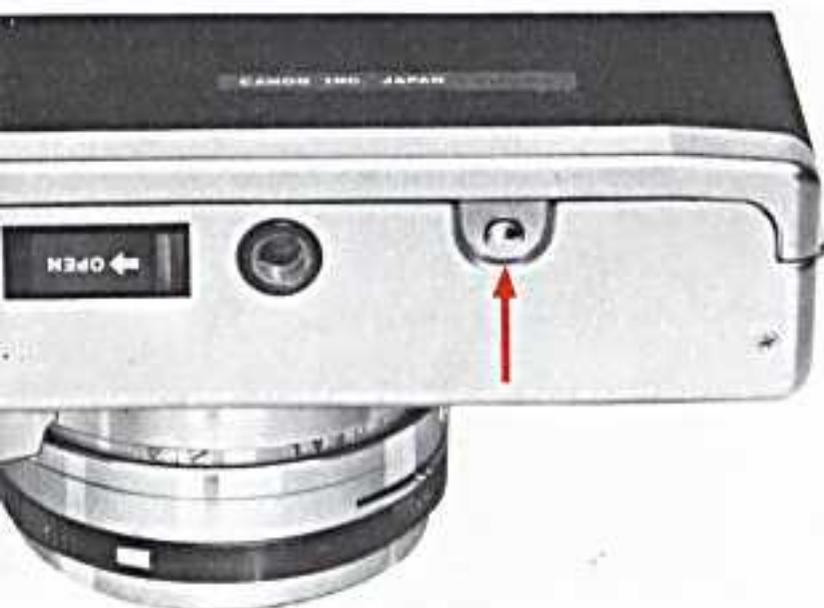
Wenn Sie die letzte Aufnahme gemacht haben und durch einen Widerstand am Schnellschalthebel merken, daß das Ende des Films erreicht ist, muß der Film in die Tageslichtpatrone zurückgespult werden. Bitte beachten Sie, daß die Rückwand auf keinen Fall vor dem Rückspulen des Films geöffnet werden darf, da der dann ungeschützt in der Kamera liegende Film durch das einfallende Licht verdorben würde.
