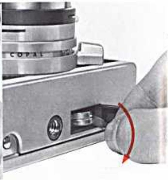
Bevor Sie Ihre Canonet G-III benutzen, muß die zur Stromversorgung der Belichtungsautomatik erforderliche Quecksilberbatterie 1,3 V, M 20 (Nr. 625) eingelegt werden. Dieser Batterietyp entspricht der Mallory PX-625 oder Eveready EPX-625.
