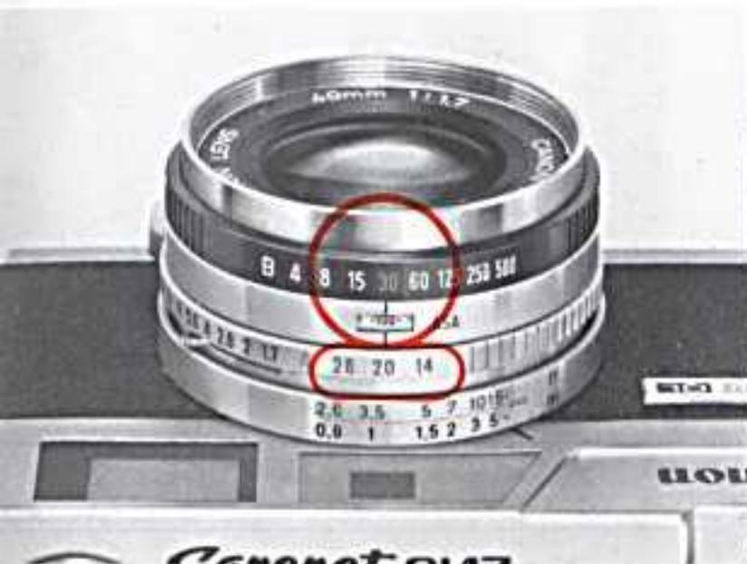
Für Aufnahmen mit Blitzautomatik sind die folgenden Kombinationen von Blitzgerät (Leitzahl) und Film ungeeignet:
