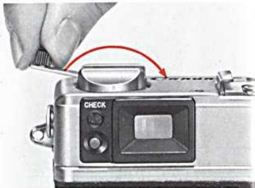
Zum Rückspulen drücken Sie den Freilaufknopf an der Unterseite der Kamera und drehen die Rückspulkurbel in Pfeilrichtung. Sobald der Freilaufknopf eingerastet ist, ist ein weiteres Drücken dieses Knopfes nicht erforderlich. Er springt später bei der ersten Betätigung des Schnellschalthebels in seine Grundstellung zurück.
