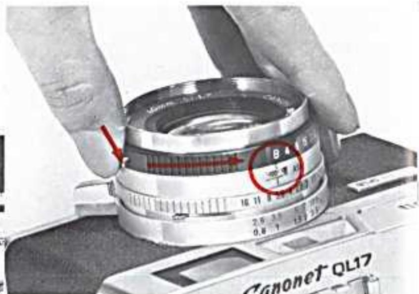
Für Zeitaufnahmen ist der Verschluss der Canonet G-III mit einer "B"-Einstellung versehen. In diesem Fall stellen Sie die Blende je nach den Erfordernissen von Hand ein, indem Sie den Blendenring aus der Stellung "A" auf den gewünschten Blendenwert drehen.
