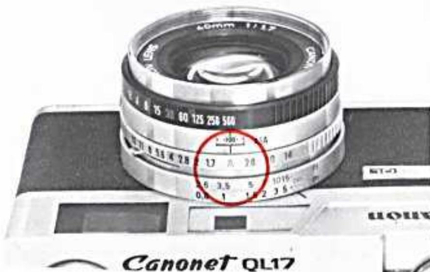
Die Belichtungsautomatik der Kamera ist mit der Filmempfindlichkeitseinstellung, der Verschlusszeit und der Objektivblende gekoppelt. Bei Aufnahmen mit Belichtungsautomatik stellen Sie den Blendenring auf "A".
