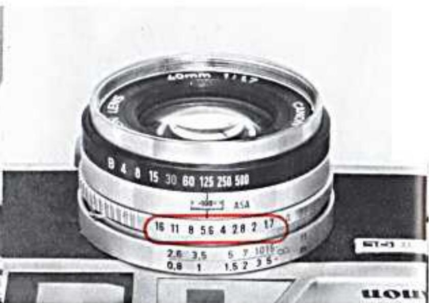
Die Canonet G-III besitzt eine abschaltbare Belichtungsautomatik und läßt Ihnen damit volle gestalterische Freiheit zur Erzielung besonderer Effekte durch freie Wahl der Verschußzeit und Blende. Wünschen Sie die Belichtungsautomatik abzuschalten, so drehen Sie den Blendenring aus der Automatikstellung "A" auf die jeweils gewünschte Blende.
