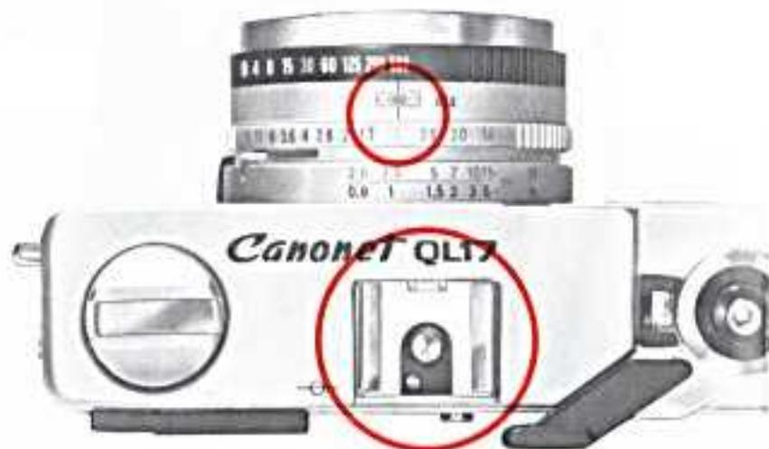
Das Canolite D ist ein Elektronenblitzgerät mit Mittenkontakt, das speziell für die Canonet G-III entwickelt wurde. Sie brauchen sich um keine Leitzahl mehr zu kümmern. Nacht- oder Inprenaufnahmen sind mit dem Canolite D genau so einfach und schnell geworden wie Tageslichtaufnahmen mit der Belichtungsautomatik der Kamera.
